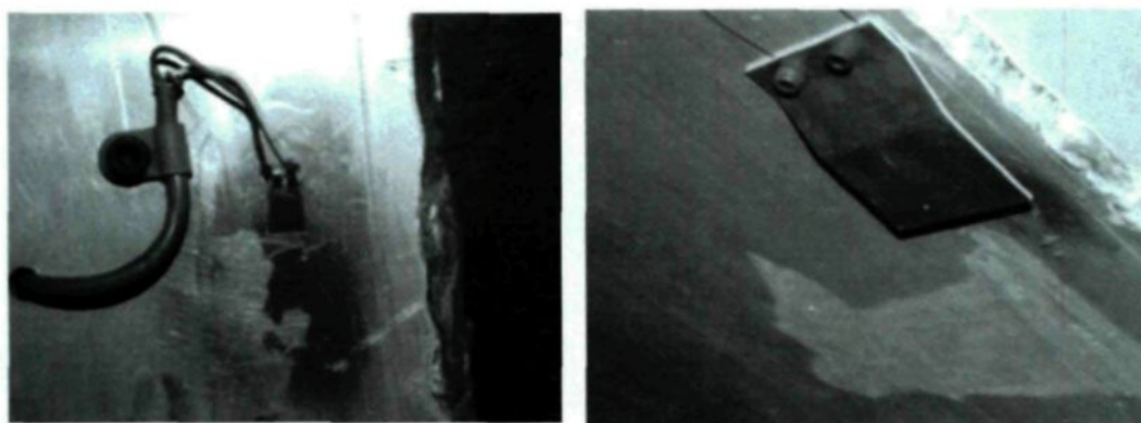
Figure 5.6 : Jauge1 et plaque de protection.
