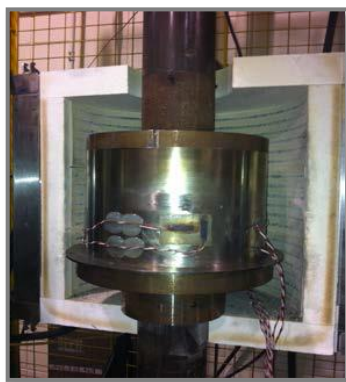
Figure 2.1 : Montage de l'essai de caractérisation de la pâte à chaud [61].
