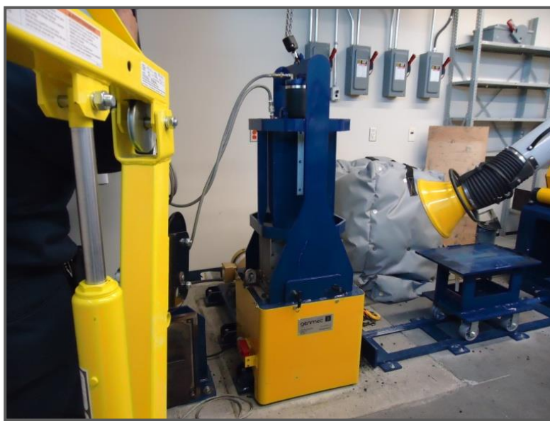
Figure 4.1 : Vibro-compacteur du laboratoire [UQAC].
