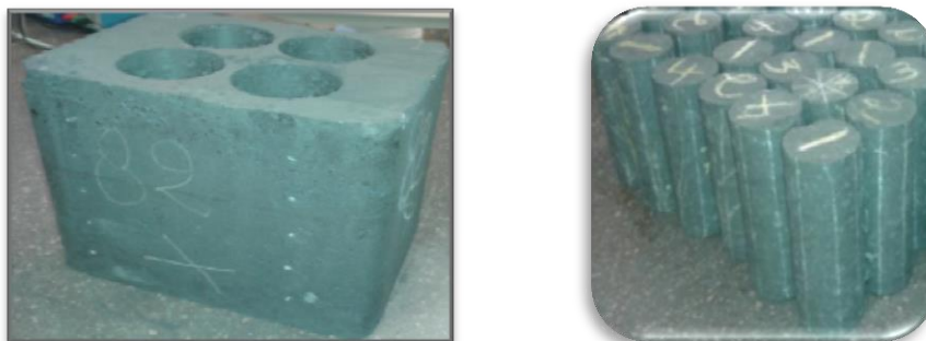
Figure 5.8 : Exemple d'une anode carottée et série d'échantillons.
