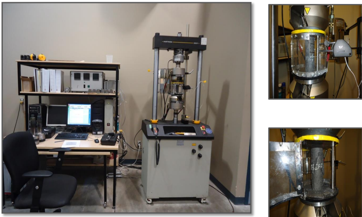
Figure 3.6 : Équipement du test de compression uniaxiale.
