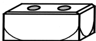
Figure 1.4 : Fissurations sur les côtés [18].
