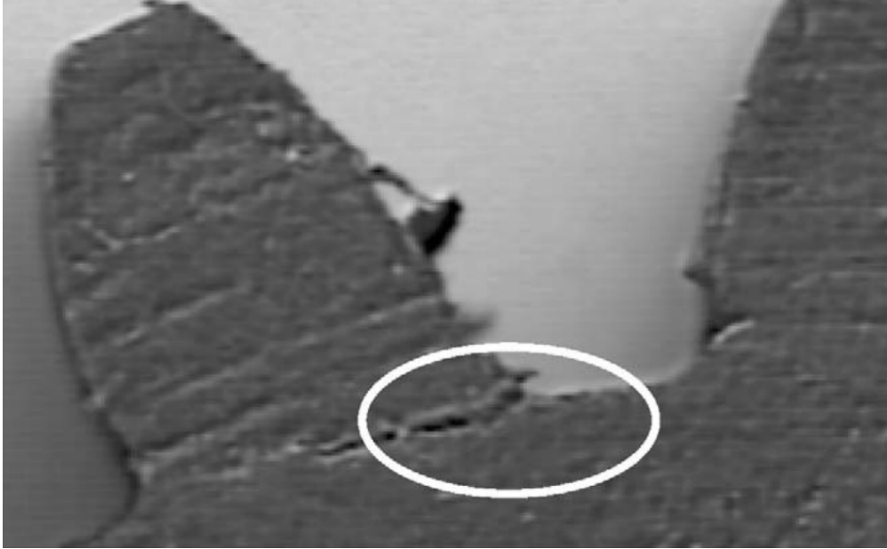
Figure II-1. Exemple de bris par fatigue à la racine (Senthilvelan and Gnanamoorthy 2004).
