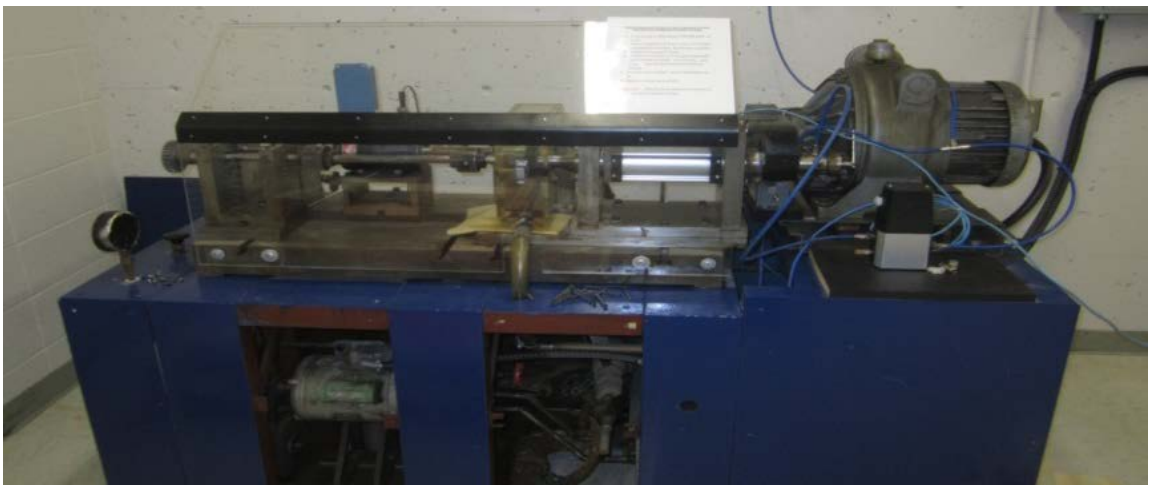
Figure III-5. Équipement utilisé pour tester les engrenages.
