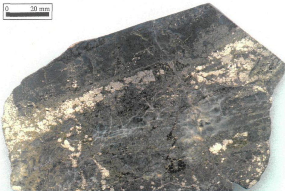
A. Assemblage chalcopyrite-pyrrhotite (pyrite). La chalcopyrite et la pyrrhotite en veinules et dans les fractures remplacent la pyrite maintenant en cristaux résiduels. Échantillon SL-E.
