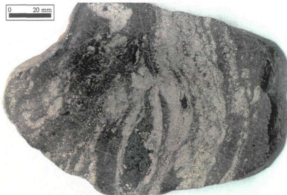
A. Assemblage de sphalérite-pyrite rubané. Partiellement recrystallisés, les cristaux sont sub-idiomorphes. Granulométrie 0,5mm pour la pyrite et de 1 à 2 mm pour la sphalérite. Échantillon SL-F.
