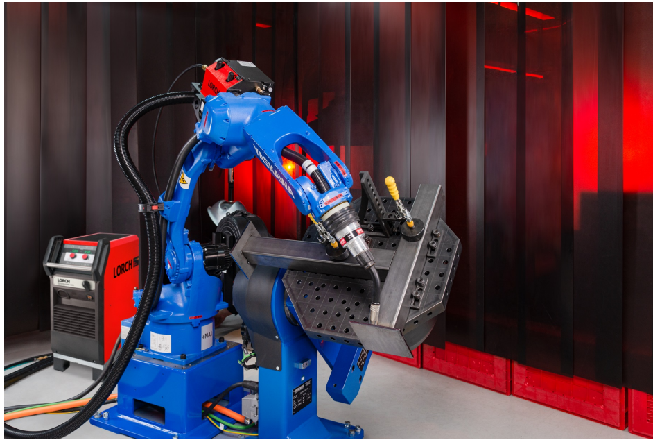
FIGURE 1.4 : Exemple de configuration avec robot (en bleu) et source (en rouge). Image provenant de lorch.eu
