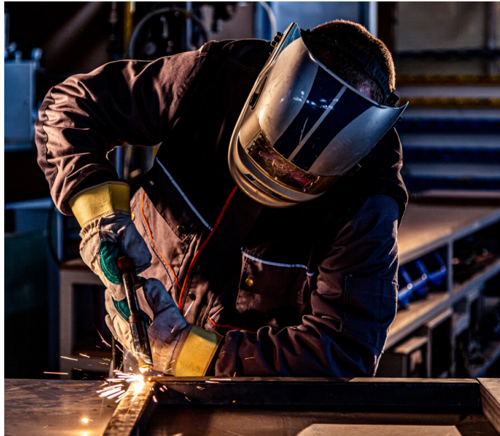
FIGURE 1.3 : Soudeur effectuant manuellement une soudure GMAW. Image provenant de topweld.ca
