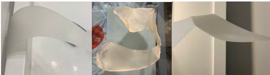
Figure 26 : Plis non contrôlé sur le PLA réactifs © Ariane Michaud, 2024
