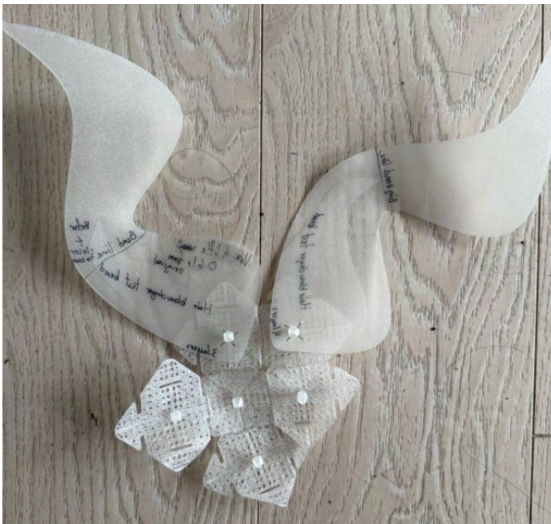
Figure 29 : Projet final, pièces supérieures en PLA réactifs attachées sur le TPU © Ariane Michaud, 2024
