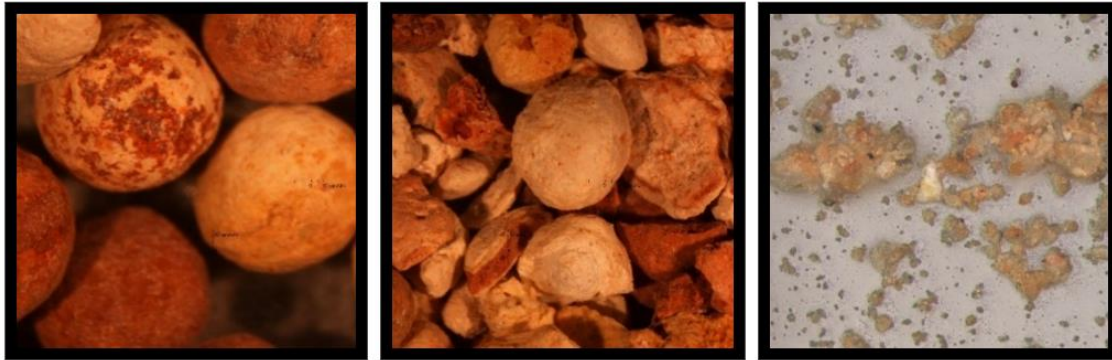
Figure 5.7 : Échantillons de bauxite : 4 mm, 1 mm et 45 \text{ }\mu\text{m}
