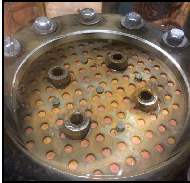
Figure 5.22 : Photo de la première version de la plaque de diffusion
