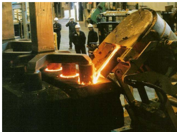
Figure 1-10: Scellement à la fonte permettant la formation du connecteur anodique [11]
