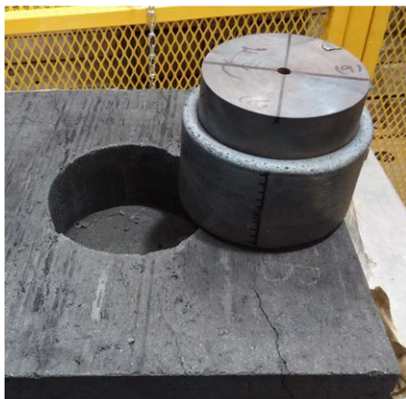
c) Assemblage test coulé à la fonte chez AAI
