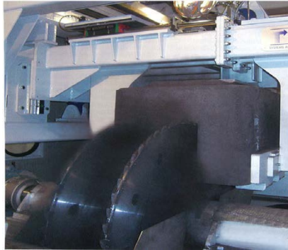
Figure 1-9: Usinage de rainures longitudinales dans une anode cuite [3]
