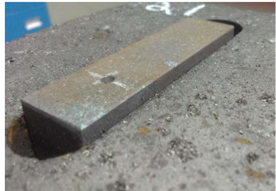
b) Élément de connexion confiné après cuisson
