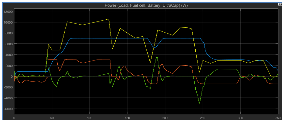
Figure 4-54 Courbes de puissances de toutes les sources et de la charge. [93]
