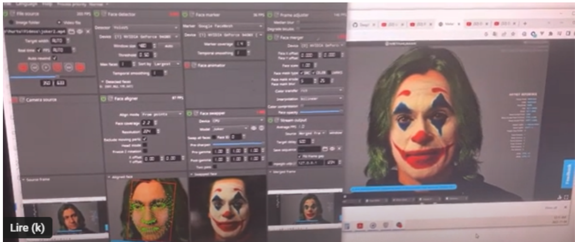
Figure 6 : Prédiction en temps réel avec un modèle DeepFaceLive et Meta Human. David Hurtubise
