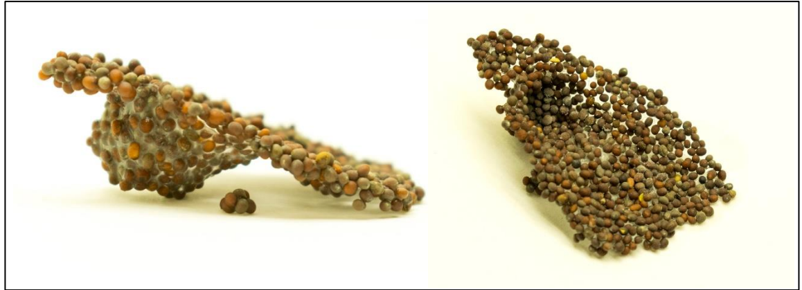
Figure 5-7 : Photos d'un radeau produit après l'injection de graines de moutarde, préalablement, refroidies avec de l'azote liquide
