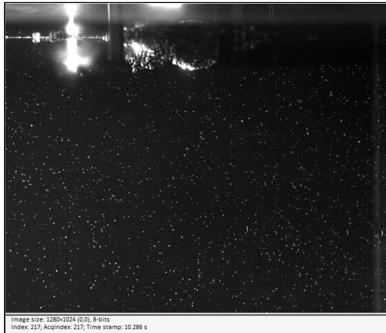
Figure 5-19: Image réelle capturée par la caméra utilisée avec le PIV
