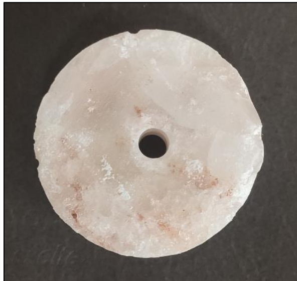
Figure 5-13: Photo d'un échantillon de sel de l'Himalaya découpé pour l'expérience
