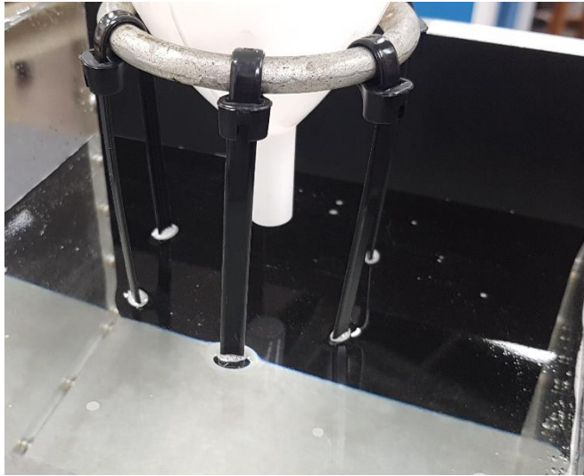
Figure 5-21 : Montage avec les attache-câbles pour contenir le radeau
