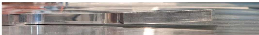
Figure 3.24. Échantillon de fatigue avec un défaut de planéité.
