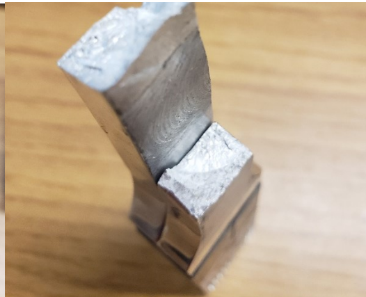
Figure C.15. FL7- Rupture dans ZATM/ZAT
