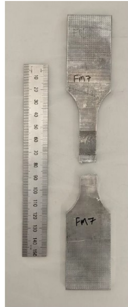
Figure C.5.FM7- Rupture dans la TMZA/ZAT
