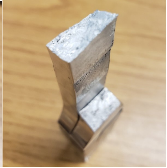
Figure C.13. FL4-Rupture dans ZATM/ ZAT
