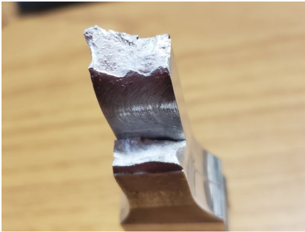
Figure C.12. FL1-Rupture dans ZM
