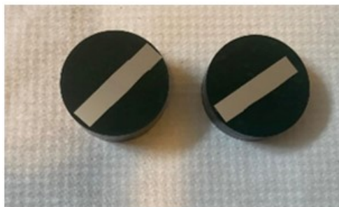
Figure 4.12. Échantillons après abrasion et polissage
