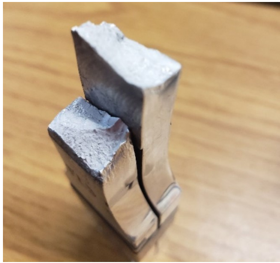
Figure C.14. FL3-Rupture dans ZM
