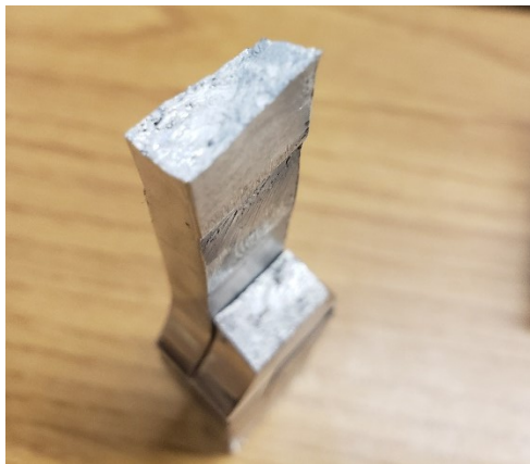
Figure C.16. FL6- Rupture dans ZATM/ZAT
