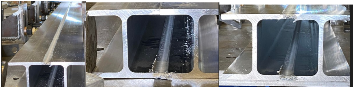
Figure 4.3. Aspect visuel de soudure finale (avec paramètres optimaux)
