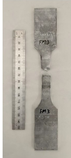
Figure C.3.FM3-Rupture dans la TMZA/ZAT
