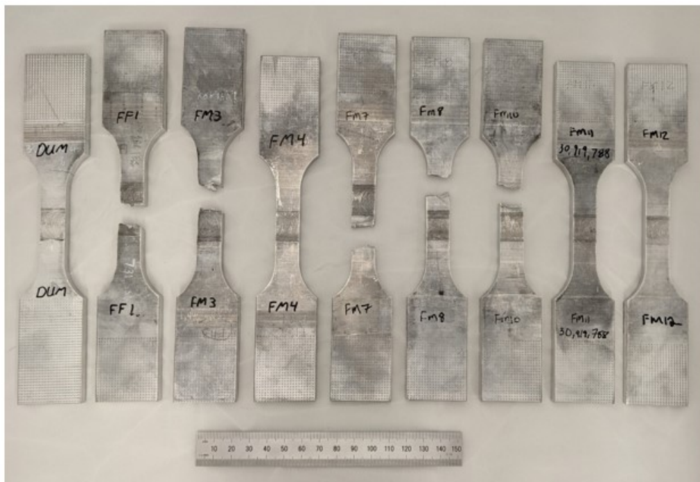
Figure 4.17 Échantillons rompus testés en fatigue
