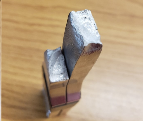
Figure C.18.FL9- Rupture dans ZM
