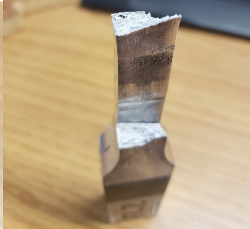
Figure C.11. FL2-Rupture dans ZATM/ZAT
