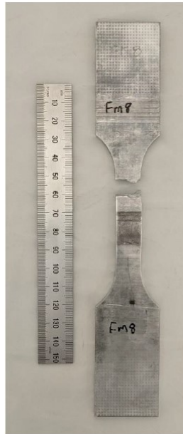
Figure C.6.FM8- Rupture dans la ZATM/ZAT
