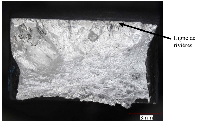
Figure 4.18 Faciès de rupture d'un échantillon (rupture dans la ZAT/ZATM)
