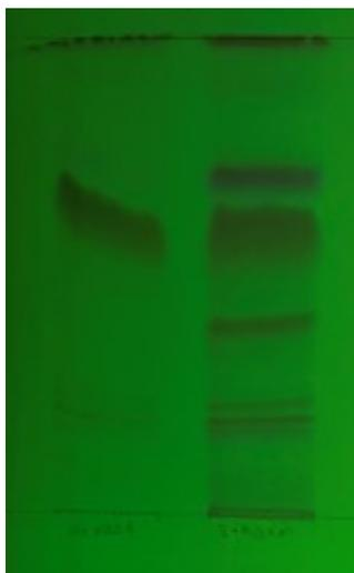
**Figure 7** : CCM de l'extrait hexanique (gauche) et de l'extrait éthanolique (droite) de bois de pin blanc (milieu d'élution : dichlorométhane/méthanol 40 : 1, UV 254 nm, sans révélateur)
