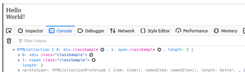
FIGURE 2.9 : Représentation du résultat d'une structure HTML avec la méthode getElementsByClassName
