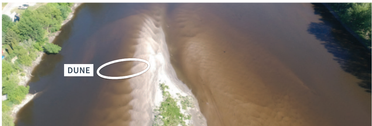
Figure 43. Exemple de configuration dunes/rides; les rides sont des micro-formes similaires aux dunes qui peuvent se retrouver entre les dunes (© LERGA-UQAC). Il s'agit d'un contexte où F6 ne serait pas
