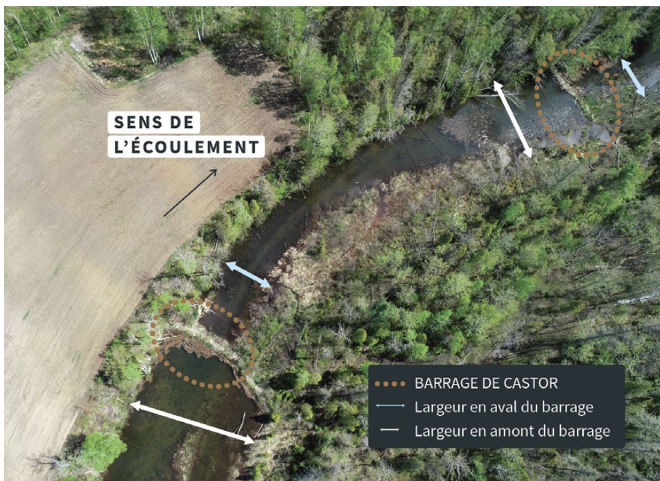
Figure 46. Exemple de barrages de castor aux effets morphologiques similaires à certaines structures anthropiques sur le patron en plan (voir Figure 45); ici, l'identification du barrage de castor comme cause fait en sorte que F7 demeure en classe A (@LERGA-UQAC)
