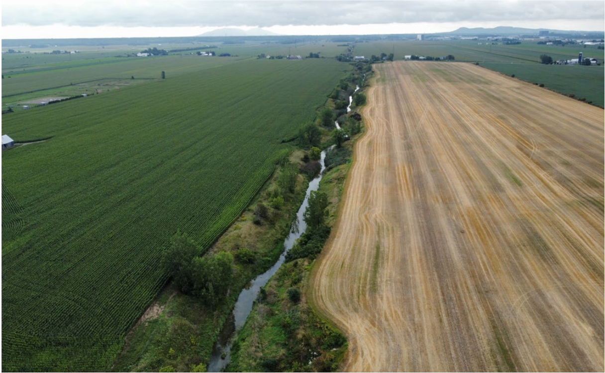
Figure 8. Exemple de cours d'eau artificiellement confiné, mais naturellement non confiné (© Firme Rivières)
