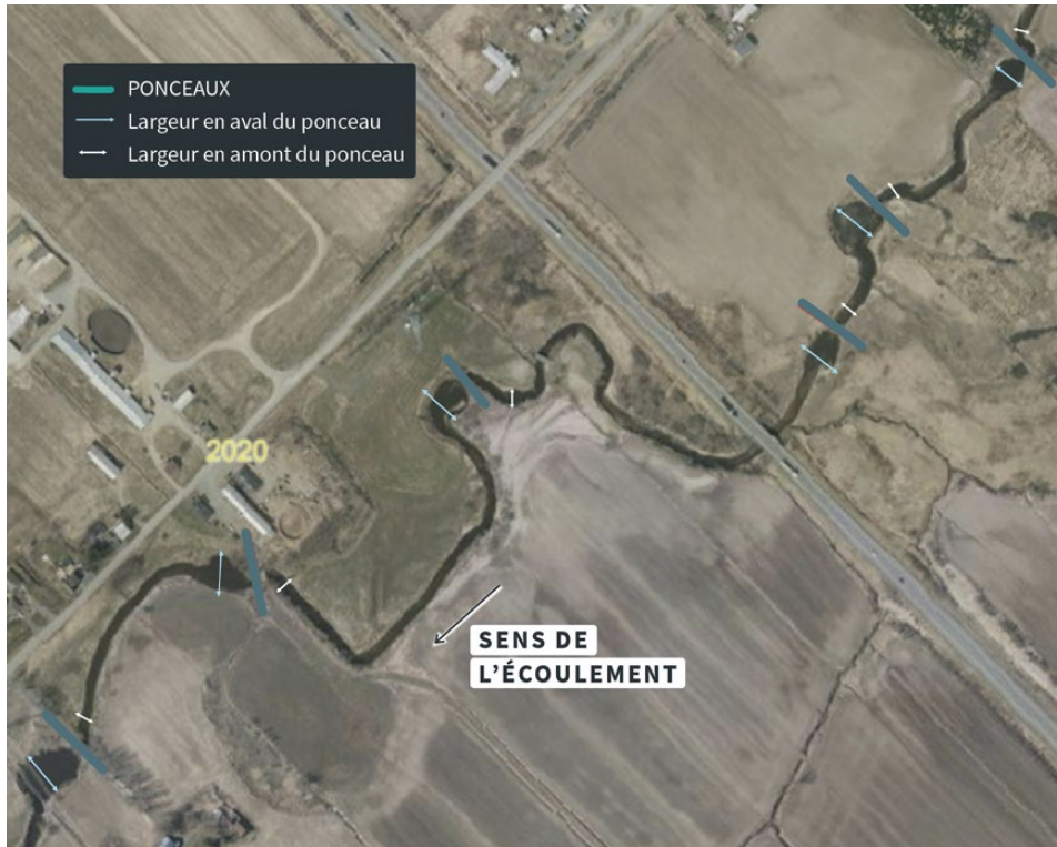
Figure 45. Exemple d'altération du patron en plan en lien avec la présence de ponceaux Service d'imagerie du Gouvernement du Québec, 2020)
