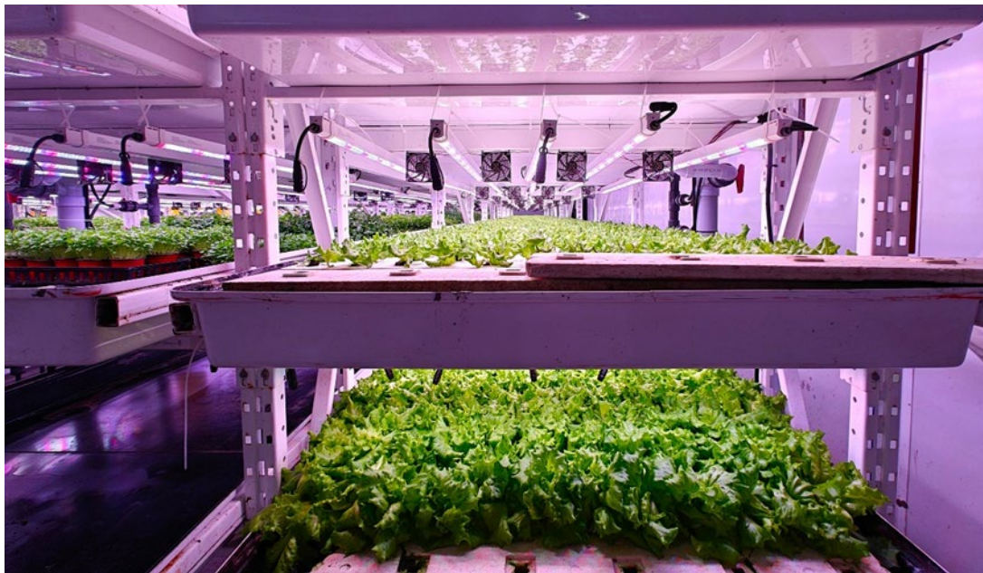
Figure 8 – Bassins modulaires automatisés, capteurs de contrôle pour l'éclairage et irrigation chez AquaVerti Farms Source : Myriam Larouche-Tremblay (2024)
