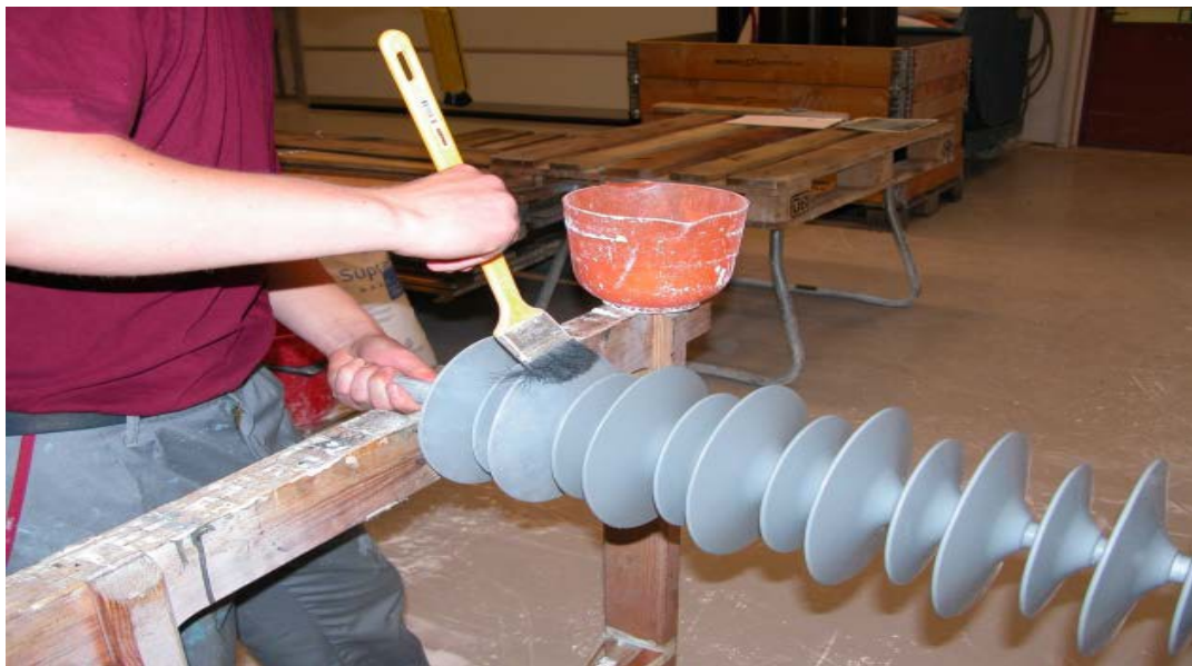
Figure 4 : Application de la poudre sèche de kaolin avec une brosse [8].
