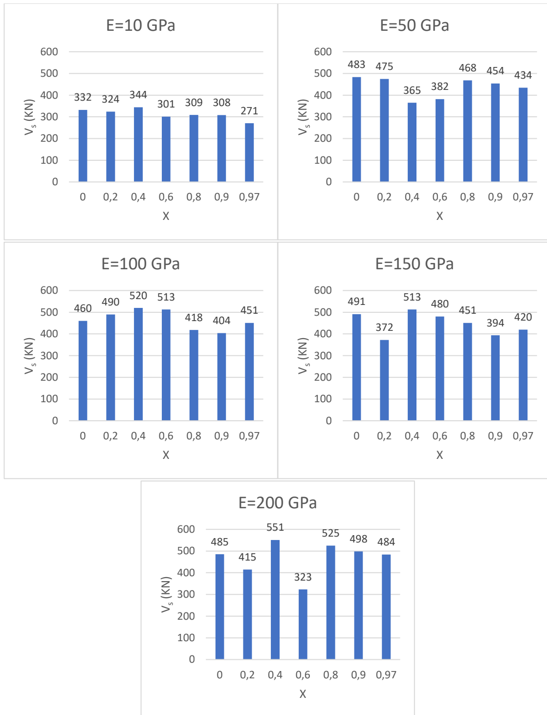
Figure 54: Contribution des barres transversales ETS liées de façon déformable à la résistance à l'effort tranchant, V_s , selon le rapport X = V_{renf} / V_0 et le module d'élasticité, E
