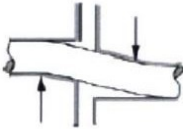
Figure 3: Représentation de l'effet goujon (tirée de Ince et al. (2007))
