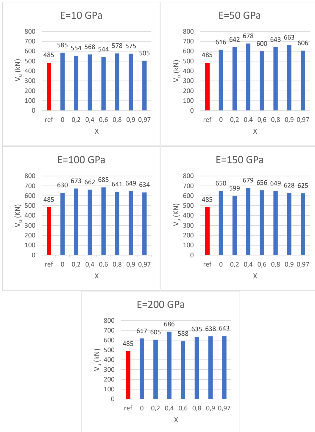
Figure 53: Résistance à l'effort tranchant, V_u , en fonction du rapport X = V_{\text{renf}} / V_0 et du module d'élasticité, E_s , des barres ETS en acier (liaison déformable) espacées de 375 mm, comparé à un spécimen sans barres ETS (ref)
