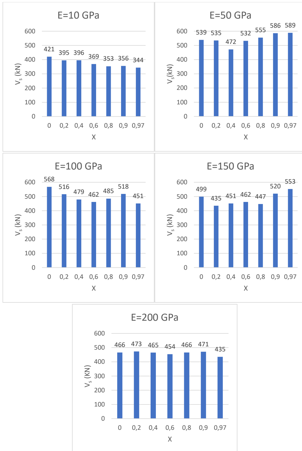
Figure 50: Contribution des barres transversales ETS liées de façon rigide à la résistance à l'effort tranchant, V_s , selon le rapport X = V_{\text{renf}} / V_0 et le module d'élasticité E
