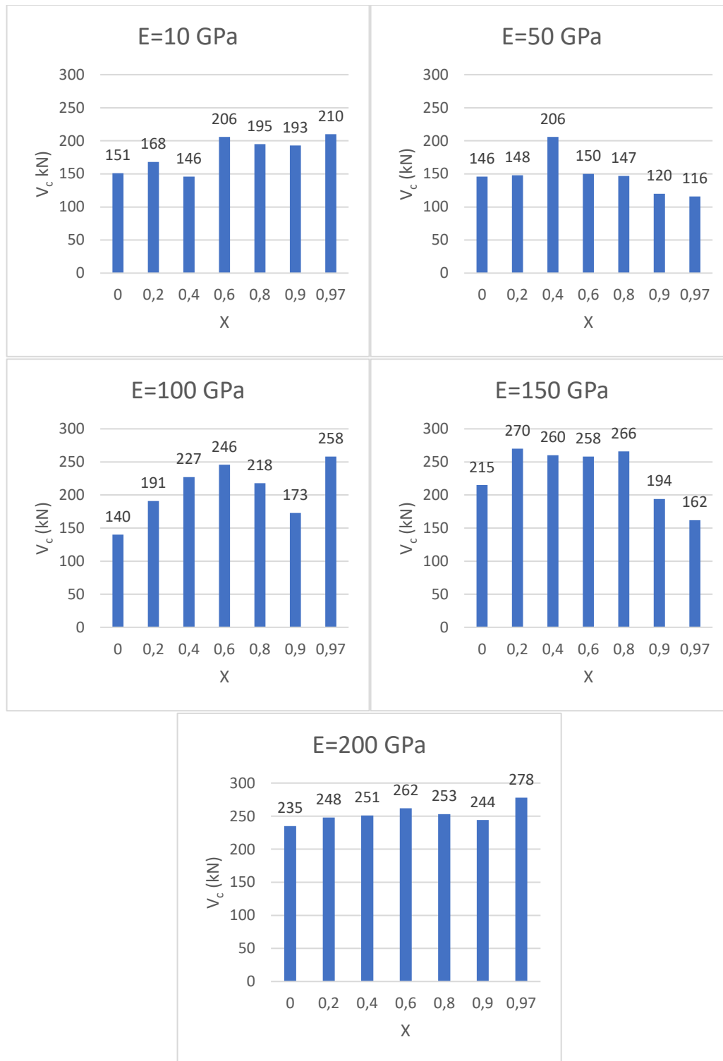
Figure 51: Contribution du béton V_c à la résistance à l'effort tranchant de la poutre renforcée avec des liaisons rigides, selon le rapport X = V_{\text{renf}} / V_0 et le module d'élasticité, E
