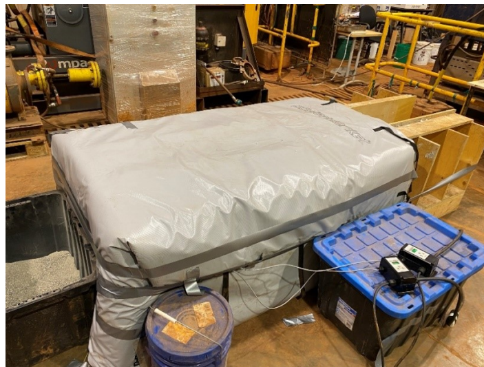
Figure 3.17 : Cure du prototype du banc de parc avec les couvertures chauffantes
