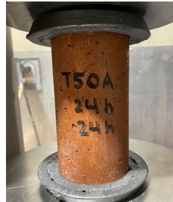
a) Confection des cylindres avant la cure b) Cylindre avant l'essai de compression
