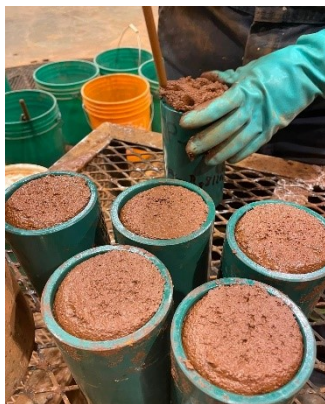
a) Confection des cylindres avant la cure b) Cylindre avant l'essai de compression
