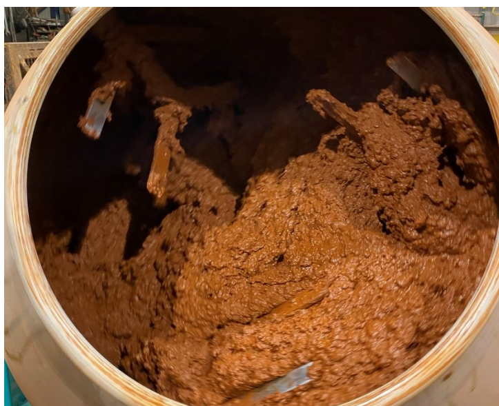
Figure 4.24 : Béton géopolymère B60-40SP lors du malaxage
