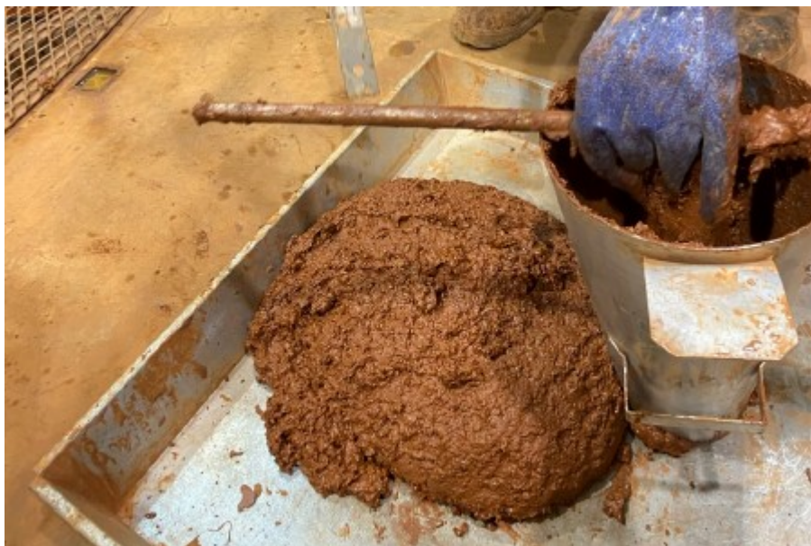
Figure 4.26 : Allure de l'affaissement du béton B60-40SP utilisé pour le banc de parc (affaissement mesuré de 210 mm)
