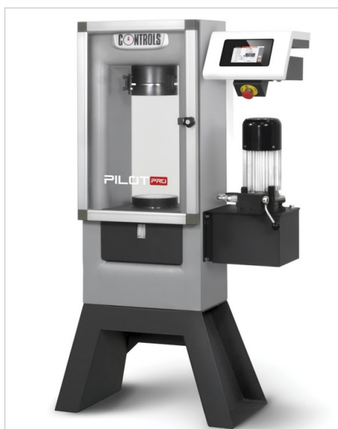
Figure 3.10 : Presse à béton automatique PILOT 1500 kN (Tiré de : Controls)
