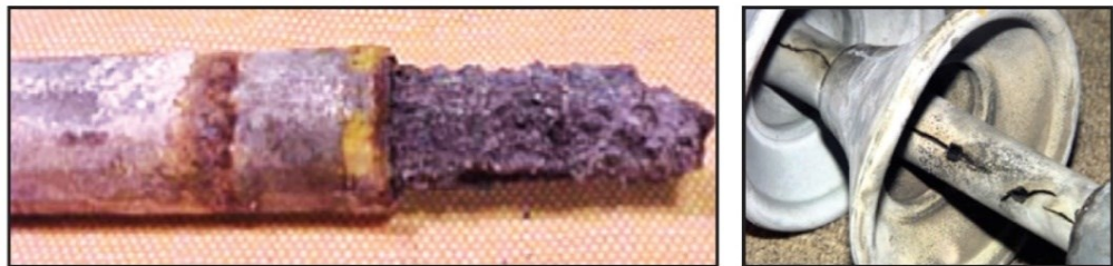
Figure 13 : Dégradation suite à un contournement interne [62].
