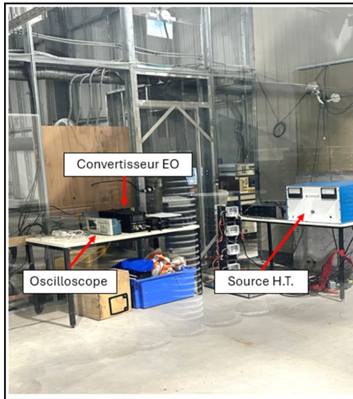
Figure 18 : Présentation de l'extérieur de la cage de Faraday.
