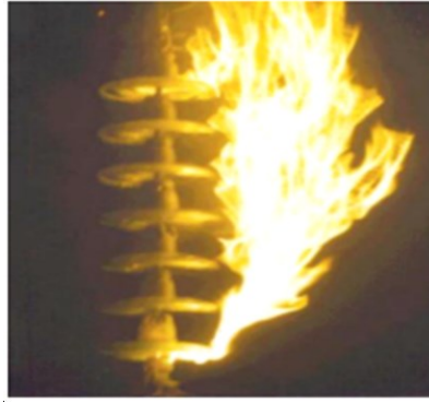
Figure 12 : Contournement externe d'un isolateur composite [18].
