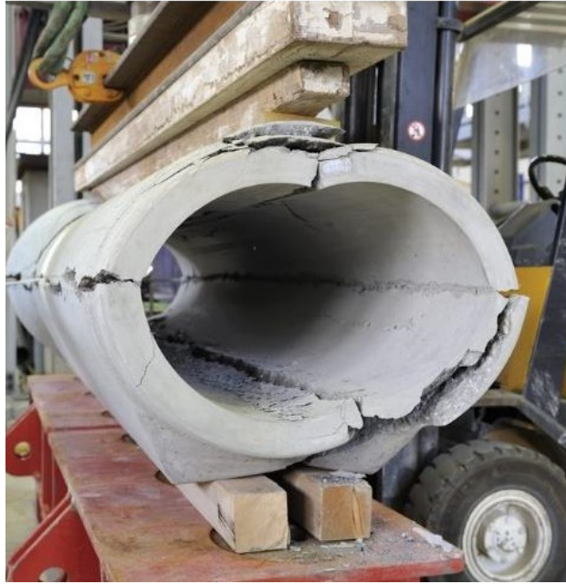
Figure 19 – Exemple d’un essai de chargement diamétral sur un tuyau de béton (Megacon Precast Concrete, 2020)
