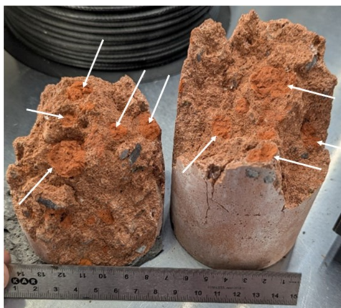
Figure 27 – Exemple de béton avec agglomérations de RB non défaits pour un cylindre avec 30% de RB
