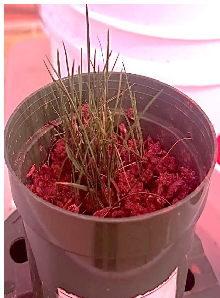
Figure 4: La croissance du gazon sur le mélange des résidus de bauxite neutralisés en utilisant un dosage de 0.83 \text{ mol H}^+/\text{kg} de solide
