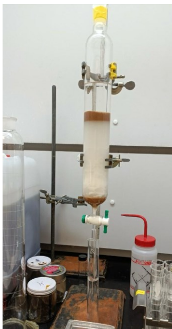
Figure 2-2 : Montage de chromatographie sur colonne pour purifier le D2EHP.
