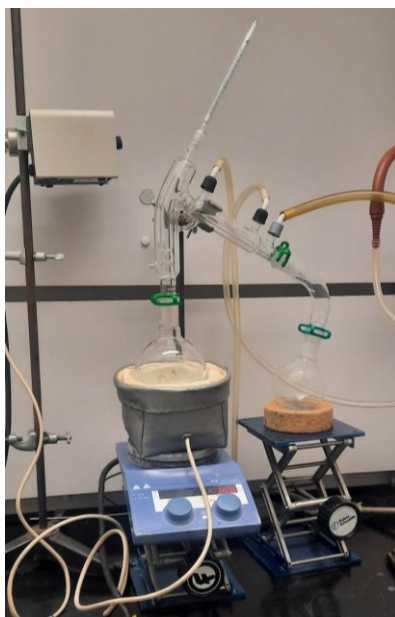
Figure 2-1 : Montage de distillation simple pour la synthèse du D2EHP.
