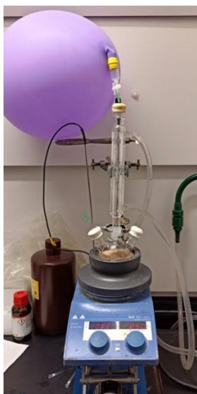
Figure 2-3 : Montage de reflux sous atmosphère d'argon pour la synthèse de [MEHMOR][2EHP].
