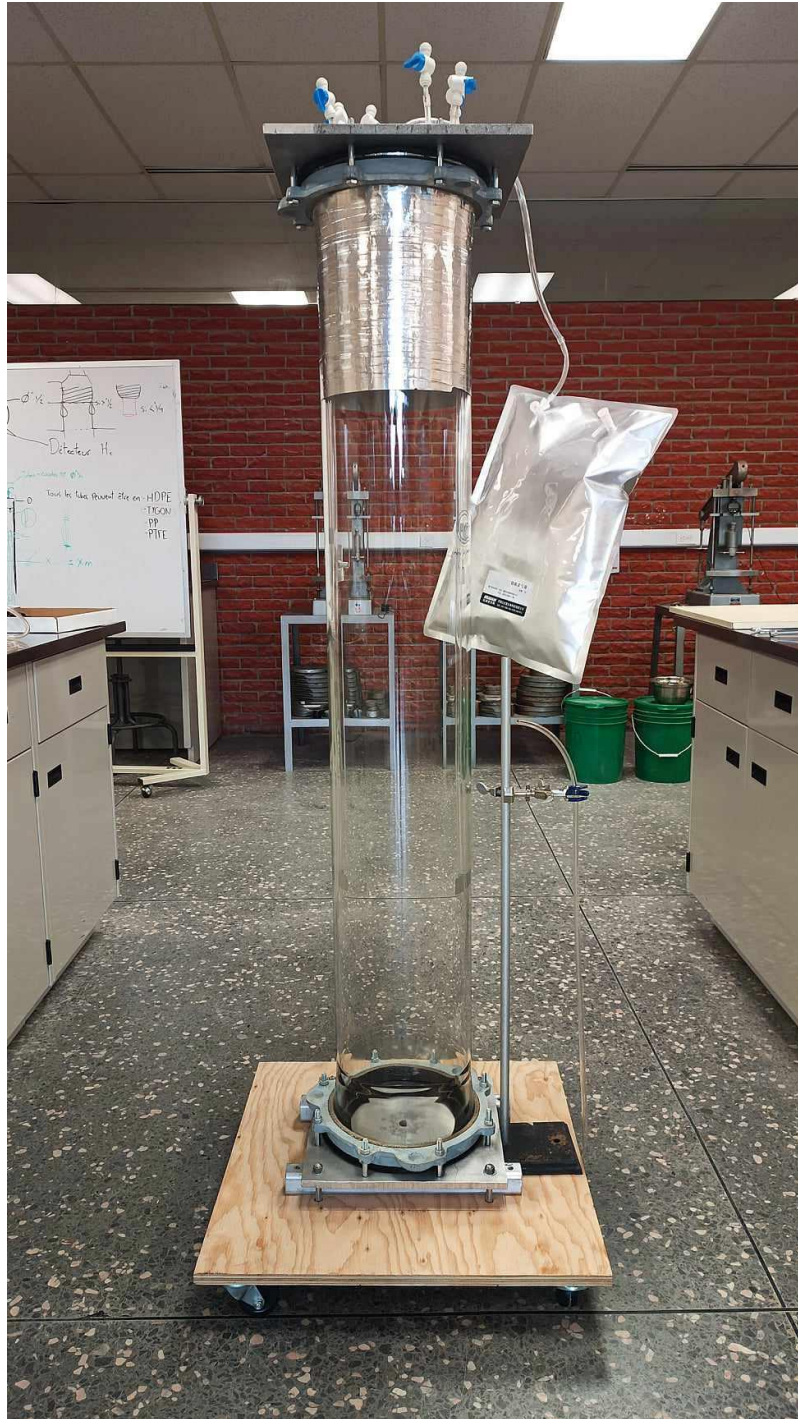
Figure 5 : Dispositif de laboratoire pour expériences sur la génération et la répartition des gaz.
