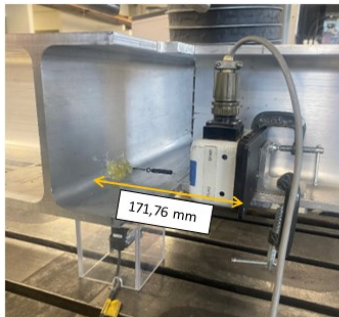
Figure 3-35: Capteur à câble placé à 171,76 mm de l'âme
