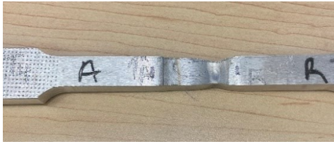
Figure 4-3: Éprouvette après rupture
