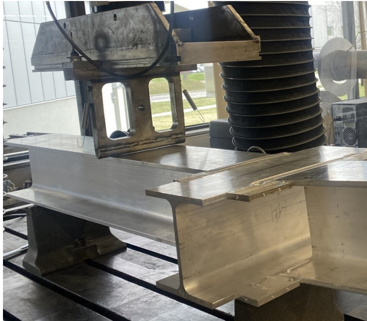
Figure 3-38: Montage de la première configuration pour essais de flexion 3 points
