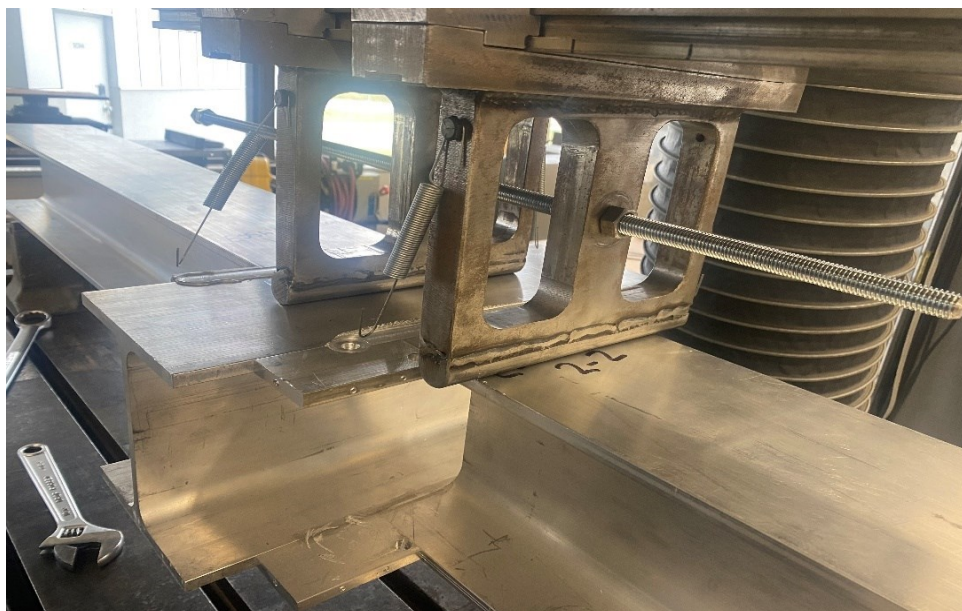
Figure 3-33: Montage de la première configuration pour essais de flexion 4 points
