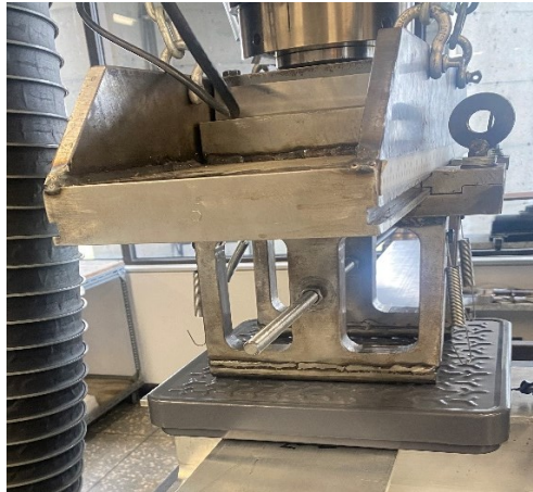
Figure 3-34: Mesure de la masse à l'aide d'une balance de la charge morte 72,6 kg
