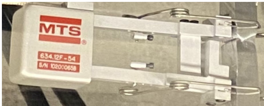
Figure 3-28: Extensomètre MTS Model 634.12F-54
