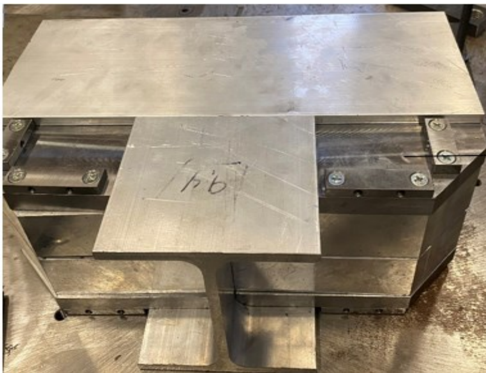
Figure 3-10: Montage des extrusions avant soudage
