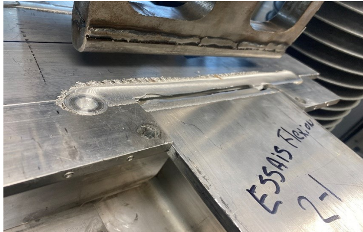
Figure 4-11: La pièce après essai de flexion
