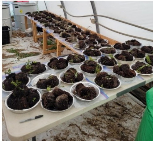
Figure 5. Représentation de l'étape de séchage à l'air des cylindres de sol de l'horizon organique dans des assiettes d'aluminium.
