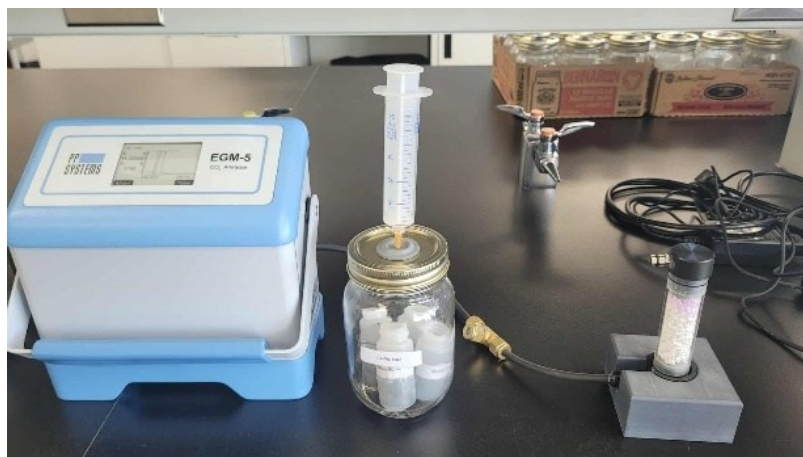
Figure 10. Représentation du système de mesure du CO 2 avec l'analyseur de gaz infrarouge EGM-5 (gauche), la chambre d'incubation avec une seringue (milieu) et le système d'injection (droite).
