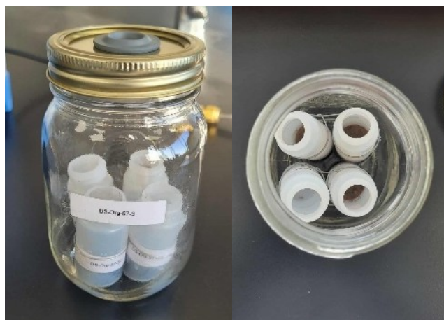
Figure 8. Exemple d'une chambre d'incubation avec une vue de l'extérieur (gauche), où on peut voir le pot Mason avec les contenants de sol humidifié et le septum sur le couvercle, et de l'intérieur (droite), où on peut voir les contenants de sol humidifié de haut.
