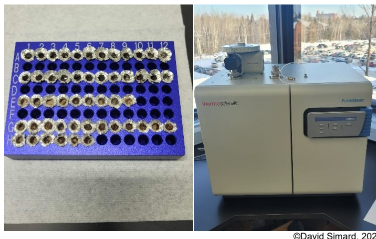
Figure 7. Représentation des échantillons de sol (gauche) dans des capsules en étains destinées à être analysées avec l'analyseur élémentaire CHNS (droite).
