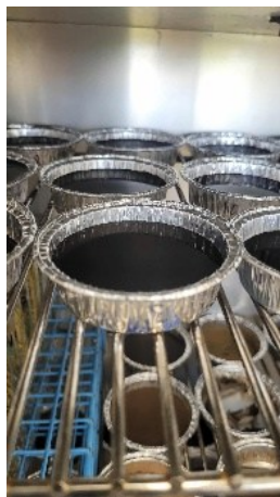
Figure 13. Représentation du séchage des échantillons de MOP et de MOAM dans une étuve, directement après les avoir transférés depuis le filtre avec de l'eau distillée, jusque dans la cupule en aluminium.
