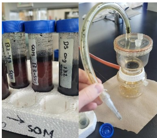
Figure 12. Représentation du deuxième cycle de séparation de la MOP avec la décantation (gauche) et le prélèvement (droite).
