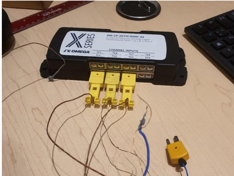
Figure 2.10 Module OmegaTM X Series de mesure de températures et thermocouples [55]
