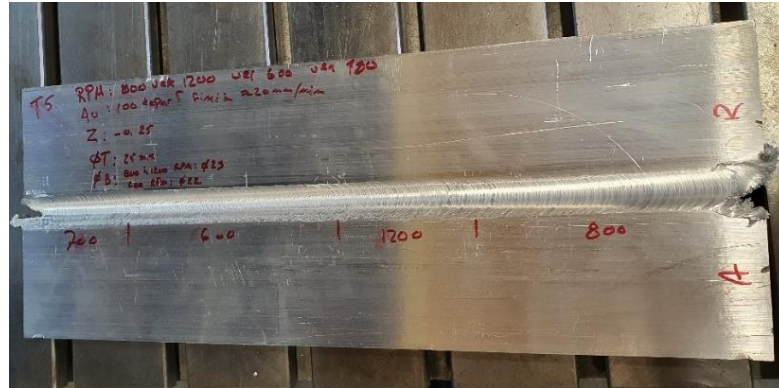
Figure 2.7 Soudure obtenue après un essai préliminaire de BT-FSW avec l'outil A avec variations des vitesses d'avance (20 à 100 mm/min) et de rotation (600 à 1200 tr/min)
