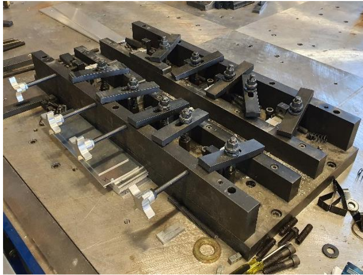
Figure 2.2 Gabarit de maintien des plaques d'aluminium pour assemblage par BT-FSW
