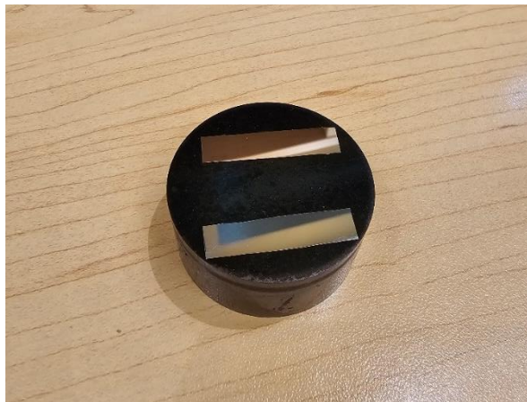
Figure 2.19 Pièce d'enrobage de surfaces de sections de soudure dans une résine de graphite pour des analyses EBSD
