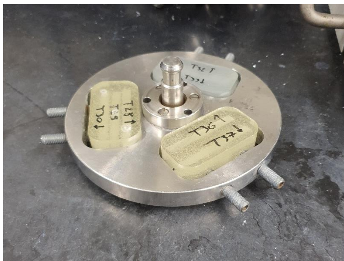
Figure 2.14 Support de maintien avec application de force centrale répartie aux pièces d'échantillons enrobés pour le ponçage et le polissage
