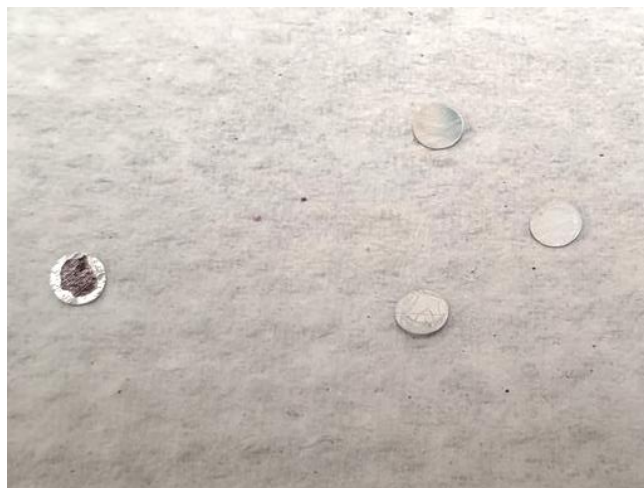
Figure 2.22 Échantillons de soudure pour des analyses par microscopie électronique à transmission
