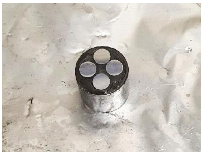
Figure 2.23 Échantillons pour analyses par MET collés sur le support pour polissage
