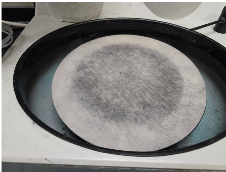
Figure 2.15 Surface de polissage des sections de soudure
