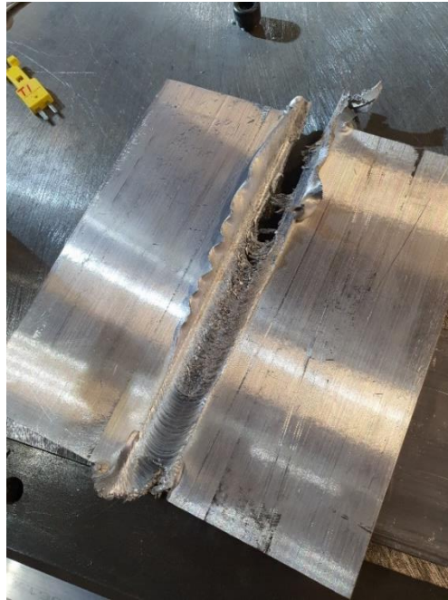
Figure 2.8 Soudure obtenue après un essai préliminaire de BT-FSW avec l'outil A avec un écartement resserré à 5,5 mm
