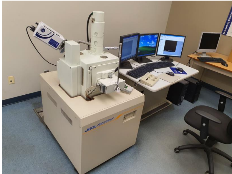
Figure 2.21 Microscope électronique à balayage JEOL JSM-6480LV, équipé d'instruments d'analyse EBSD [64, 66]
