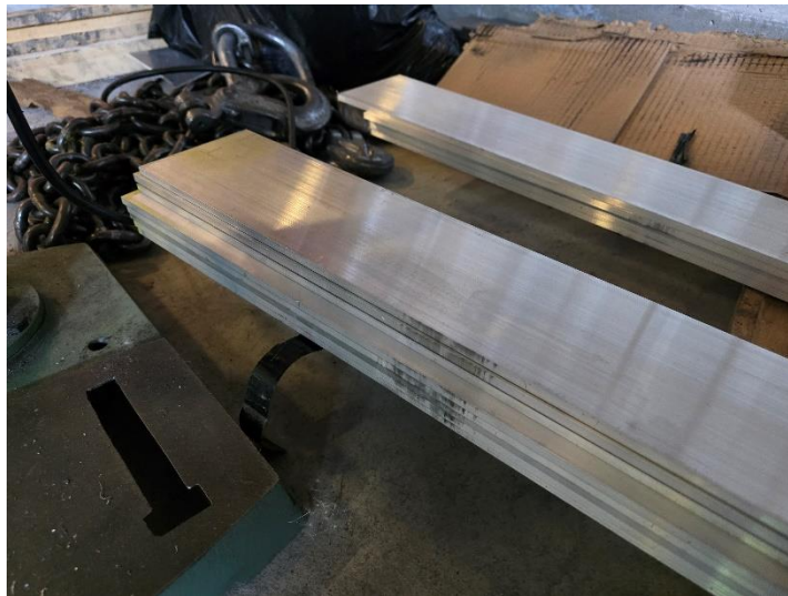
Figure 2.1 Longueurs d'alliage 6061-T6 à disposition au CSFM pour les essais de BT-FSW
