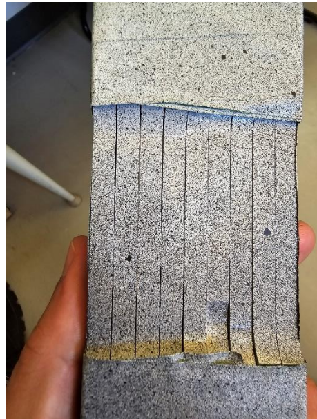
Figure 2.33 Tranches peintes des éprouvettes de traction pour les essais avec analyse DIC
