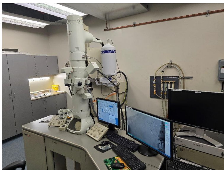
Figure 2.27 Microscope électronique à transmission JEOL JEM-2100 [70]
