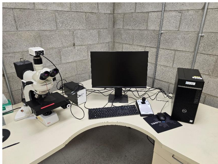
Figure 2.17 Microscope optique Leica équipé du matériel d'analyse Clemex [60, 61]
