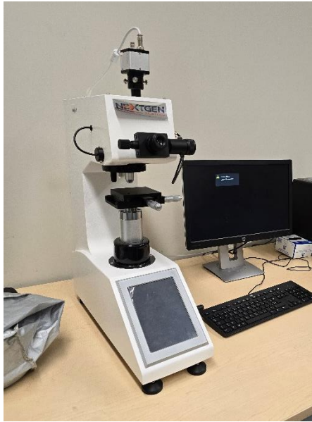
Figure 2.30 Machine de mesure de microdureté Vickers NextGen [74]
