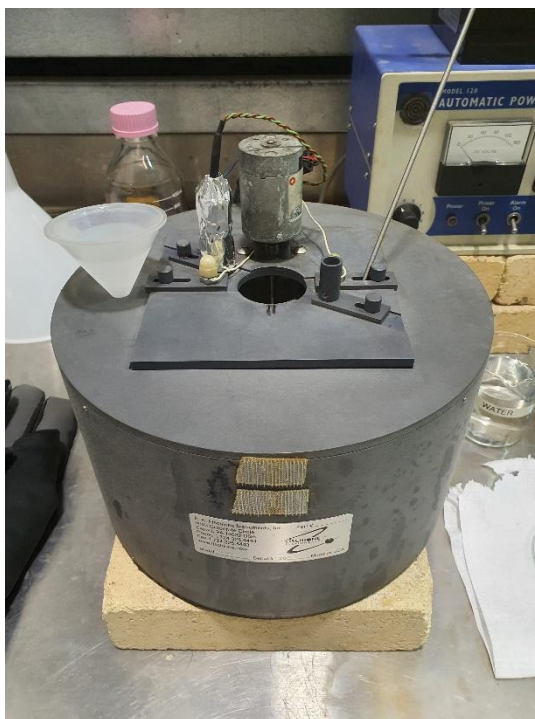
Figure 2.25 Cuve de corrosion par électro-polissage Fischione Instruments [69]
