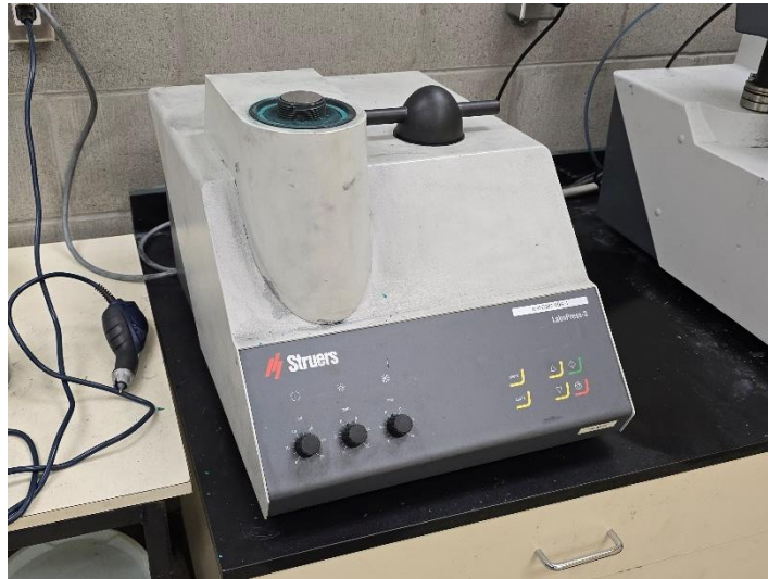
Figure 2.18 Machine d'enrobage de surfaces métalliques Struers LaboPress [63]
