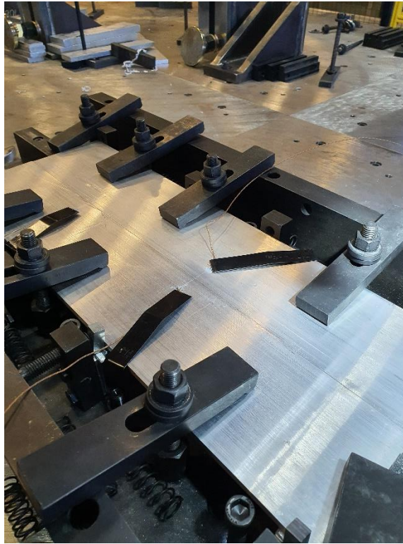
Figure 2.9 Plaques d'alliage 6061-T6 disposées sur le gabarit pour le BT-FSW, avec maintien des thermocouples
