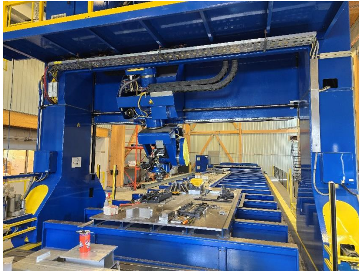
Figure 1.2 Équipement de FSW de type portique au CSFM de l'UQAC de marque Bond Technologies TM [7]
