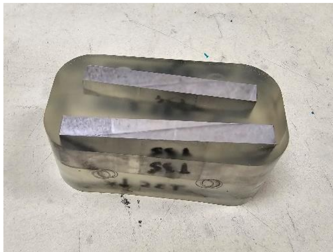
Figure 2.12 Pièce d'enrobage de sections de soudure par BT-FSW dans une en résine acrylique pour des observations par micro ou macroscopie optique
