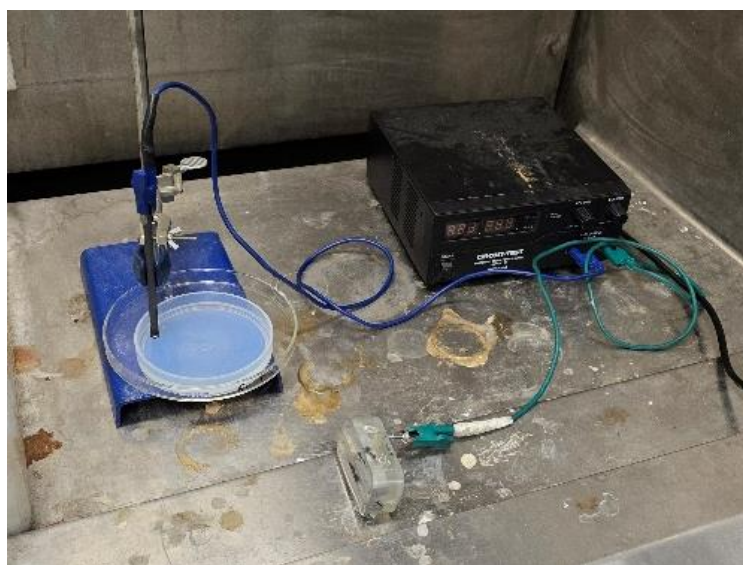
Figure 2.16 Montage et circuit électrique pour l'électro-attaque chimique des sections de soudure
