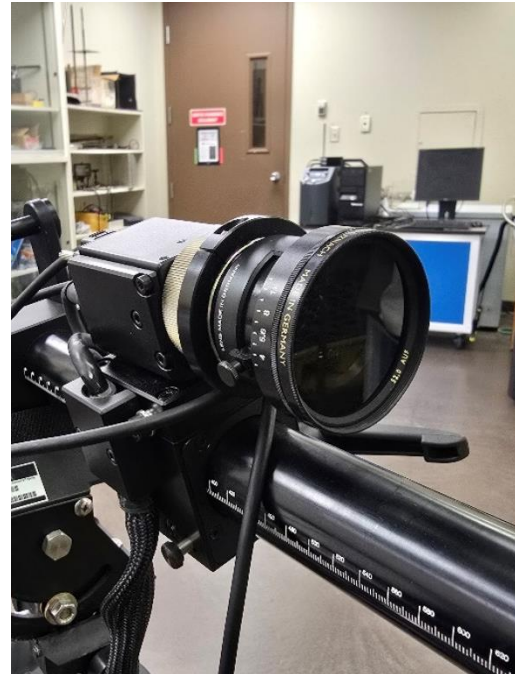
Figure 2.36 Objectif de la caméra de prise d'images pour l'analyse par DIC
