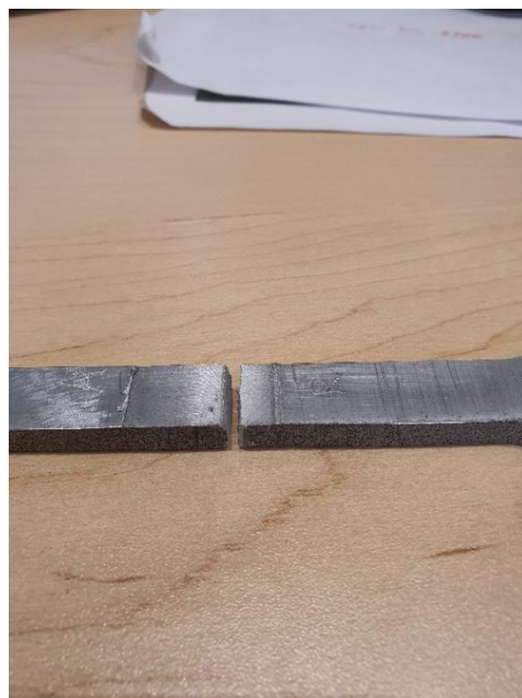
Figure 3.35 Rupture à faible déformation à l'interface de la ZM côté Recul d'une éprouvette de soudure T7
