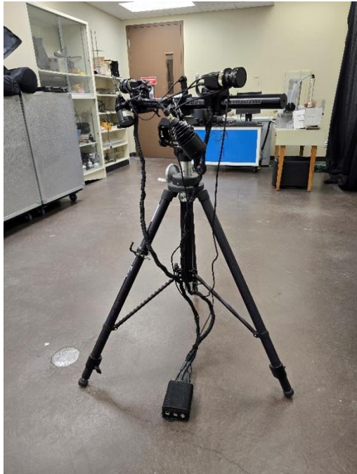
Figure 2.35 Caméra de prise d'images pour l'analyse par DIC posée sur son trépied
