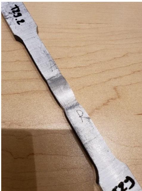
Figure 3.34 Rupture dans la ZAT côté Recul d'une éprouvette de soudure par BT-FSW
