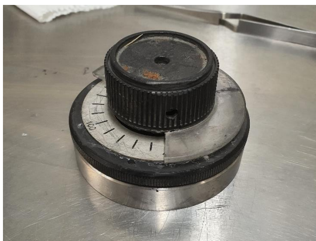
Figure 2.24 Gabarit de polissage des échantillons pour analyses par MET équipé d'un ajusteur d'épaisseur
