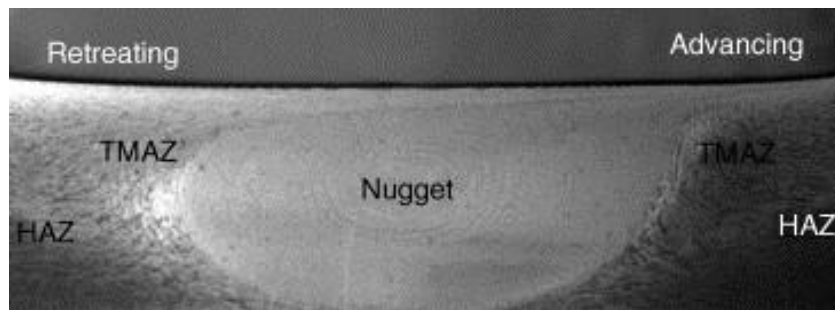
Figure 1.3 Observation macroscopique des zones de soudure de l'aluminium 7075-T651 soudé par FSW [2] © Elsevier (reproduit avec autorisation)
