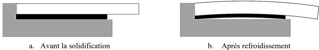
Figure 3-6 : Hypothèse de la courbure de la barre due à une contraction supérieure de la fonte par rapport à la barre collectrice
