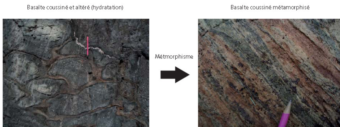
Figure 42: Photos montrant l'effet du métamorphisme et de la déformation sur un basalte coussiné.
