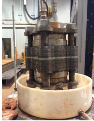
Figure 6.20 : Montage de filtration pour déterminer la perméabilité du a) filtre d'acier et b) filtre d'acier inoxydable
