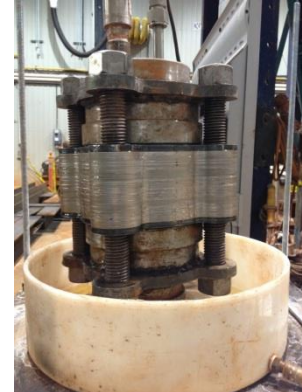
Figure 6.20 : Montage de filtration pour déterminer la perméabilité du a) filtre d'acier et b) filtre d'acier inoxydable
