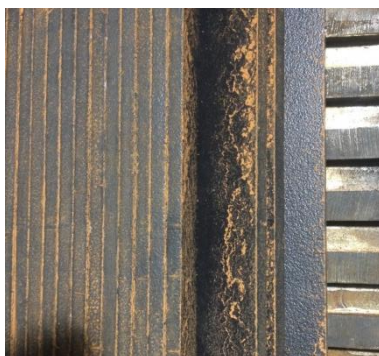
Figure 6.18 : Encrassement par les particules de boue rouge du filtre à plaque d'acier recouvert de peinture cuite
