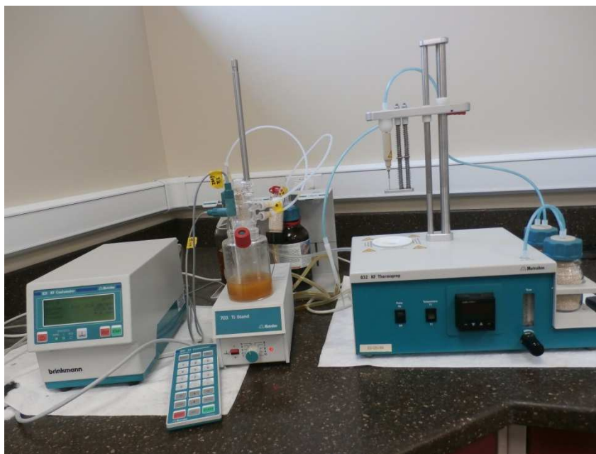
Figure 3.1 Titreur Coulométrique Karl Fisher pour la mesure de la teneur en eau.
