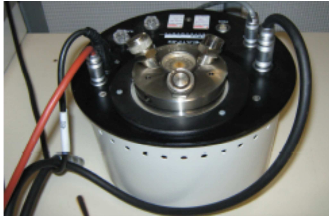
Figure 3.7 Cellule d'essai de type 2903 pour la mesure du facteur de dissipation.
