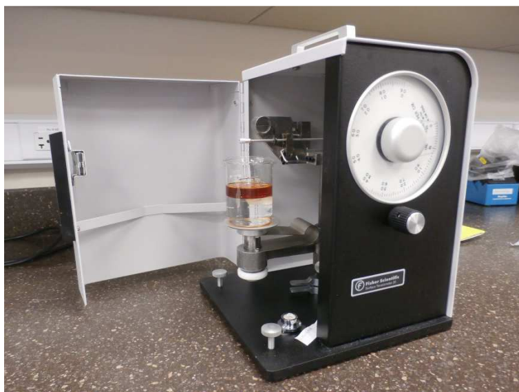
Figure 3.11 Tensiomètre de type LECOMPTE DE NOUY pour la mesure de la tension interfaciale.
