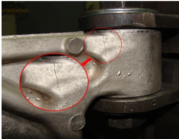
Fissure 1 er type.
