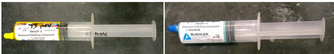
Figure 5.14: Pâte diamantée de polissage 6 et 1 \mu\text{m} .
