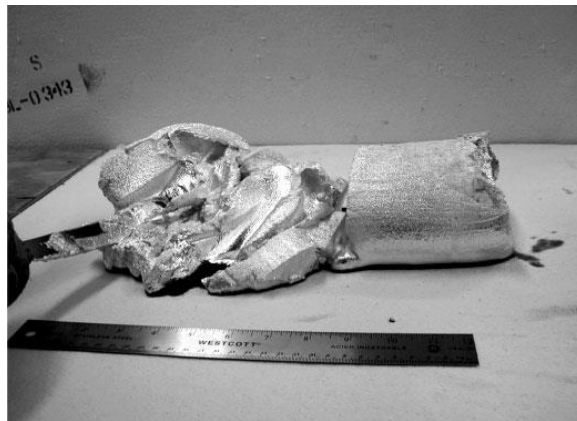
Figure 2.5: Alliage A356 traité par SEED, étalé avec une spatule [15].
