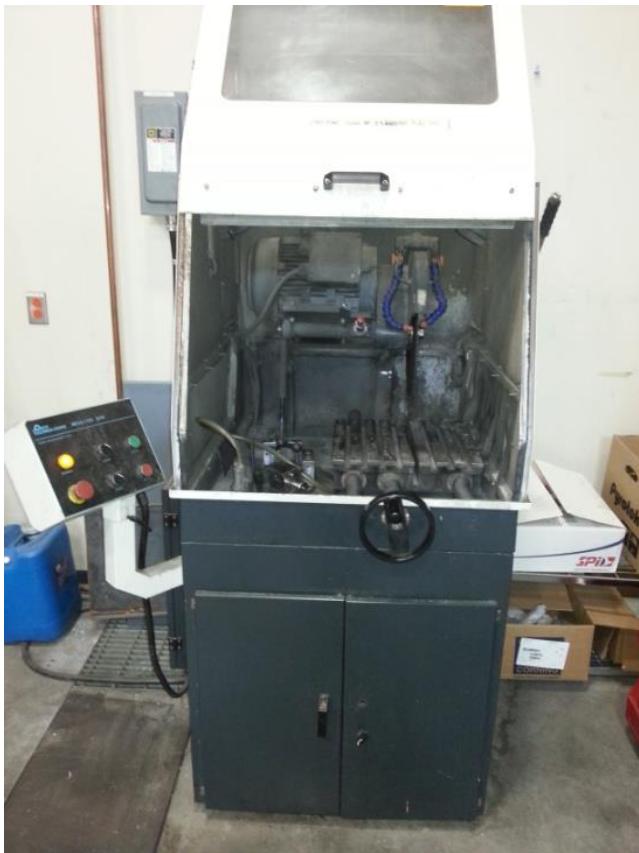
Figure 5.12: Coupeuse avec refroidissement à l'eau (Struers).
