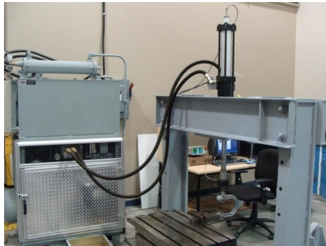
Figure 5.1: Banc d'essai de fatigue (LM 2 SA-CURAL).
