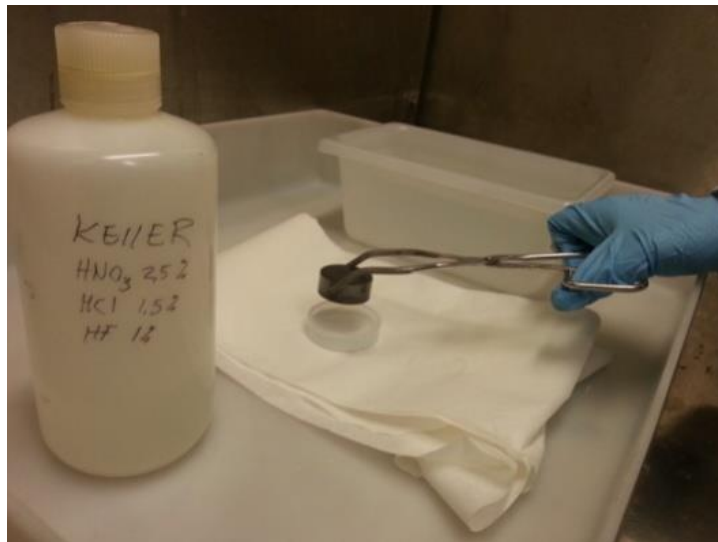
Figure 5.15: Attaque chimique au Keller.
