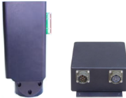
Figure 2.24: Tête de la sonde LWC-200 (gauche) ainsi que son unité de traitement de signal (droite) (Droplet Measurement Technologies, 2013)
