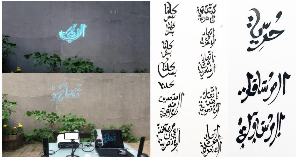
Figure 12 : Prototype de projection de calligraphie arabe en direct.
