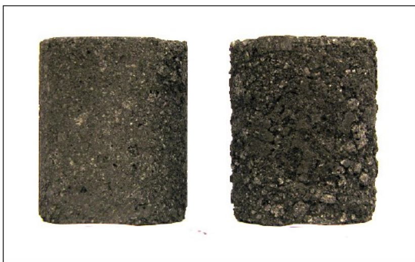
Figure 6-2 : Comparaison avant/après d'un échantillon soumis à un test de réactivité [127]. Utilisé avec la permission de "The Minerals, Metals & Materials Society".
