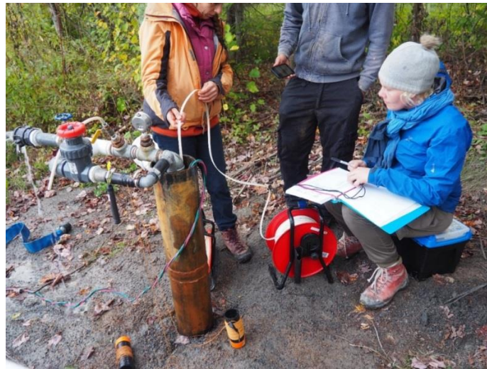
Figure 3-16 : Photo du suivi temporel du rabattement lors de l'essai de pompage du 30/09/2019 dans le puits LA-F04 (Saint-Cuthbert, Lanaudière).
