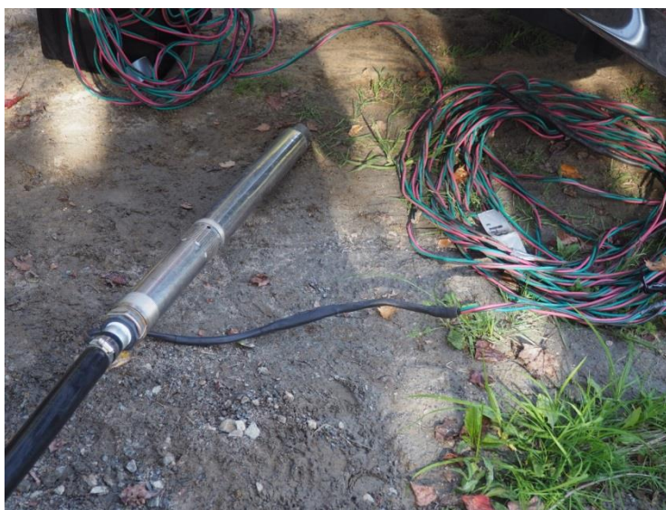
Figure 3-14 : Photo de la pompe submersible Grundfos de ¾ de force de la compagnie TechnoRem qui a été utilisée pour le pompage du 30/09/2019 dans LA-F04 à Saint-Cuthbert, Lanaudière. Les plages idéales de la pompe sont entre 15 et 30 GUS/min.
