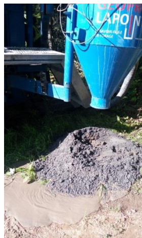
Figure 3-4 : Échantillonnage des dépôts meubles lors des forages
