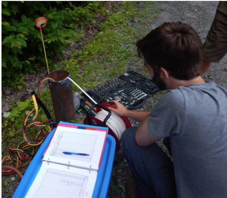
Figure 3-11 : Mesure du niveau d'eau dans le puits pendant l'essai de pompage.
