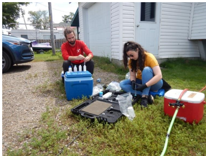
Figure 3-8 : Le prélèvement d'échantillon d'eau souterraine se fait dans des bouteilles approuvées par le laboratoire d'analyse.
