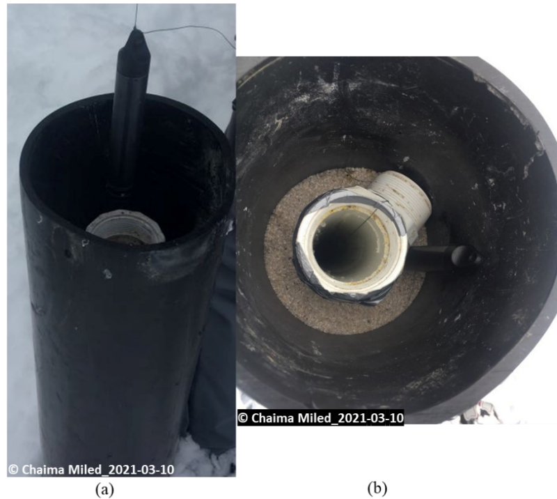
Figure 5: (a) : Installation d'un Level-Logger dans S1-BER ; (b) : Installation d'un Baro-Logger dans S4-BER.
