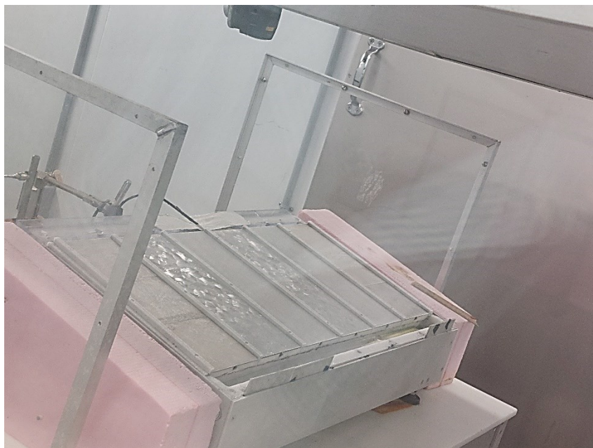
Figure 5-8 : Surfaces des revêtements au bout de 45 min d'accumulation sous HHET
