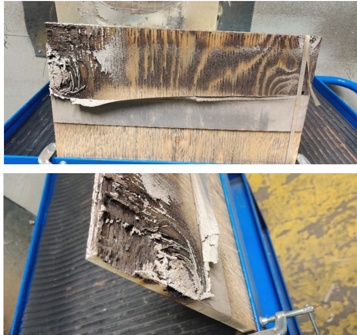
Figure 19. Effets de la projection thermique par la technologie Twin Arc sur le bois.
