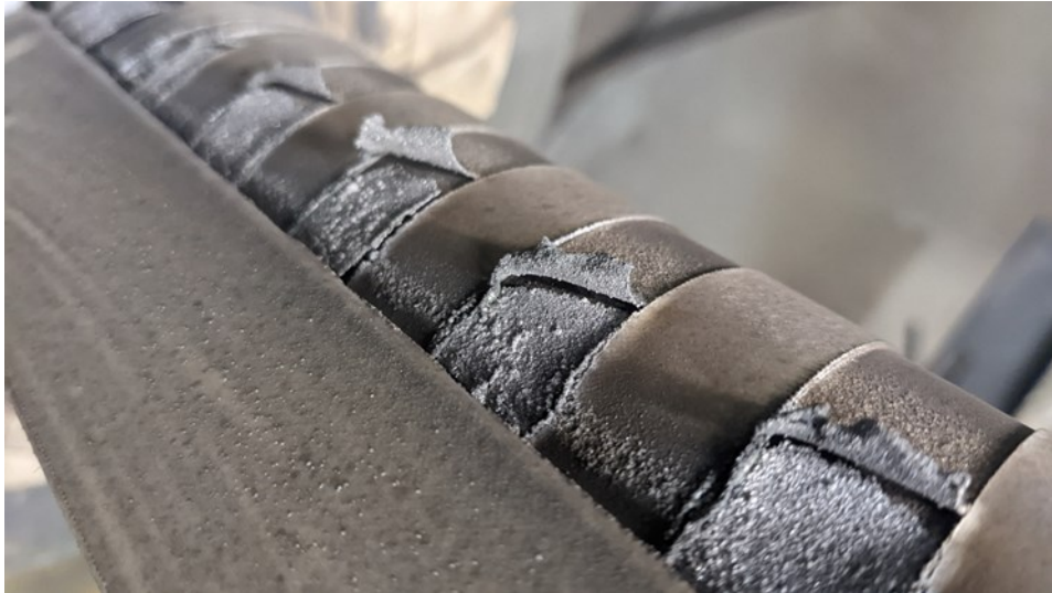
Figure 33. Projection thermique par Plasma Spray avec couche de finition plus épaisse.
