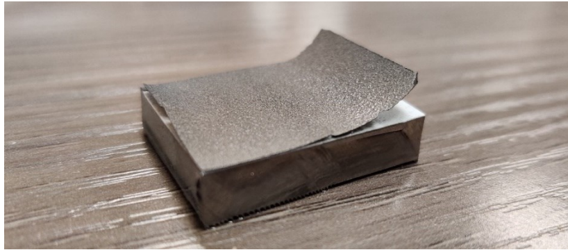
Figure 21. Effets de la projection thermique par la technologie Plasma Spray sur une base métallique.
