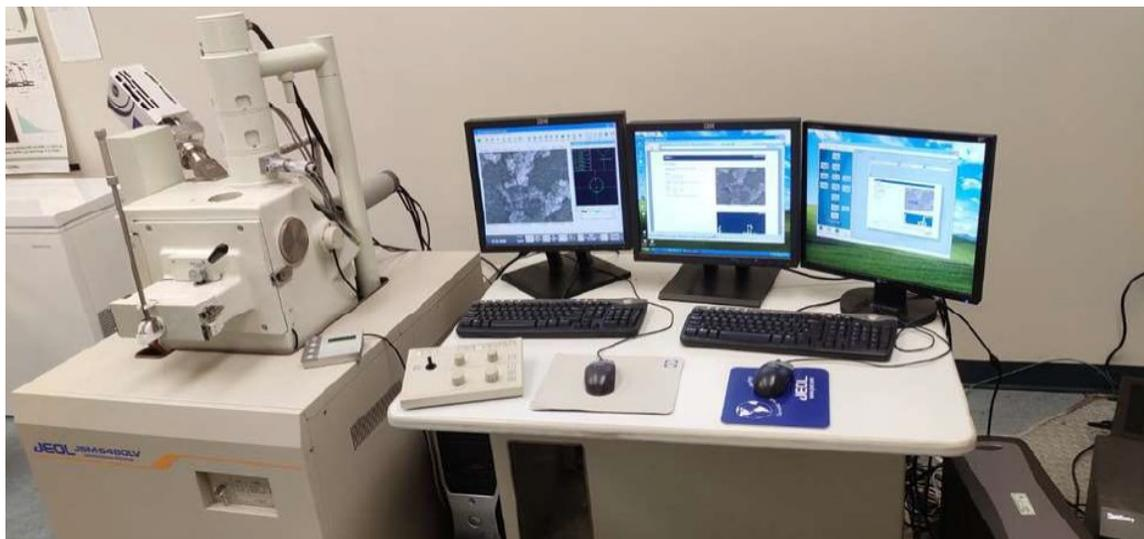
Figure 3.4 : Microscope électronique à balayage (MEB) : modèle SEM JEOL JSM 6480LV, CURAL, UQAC.
